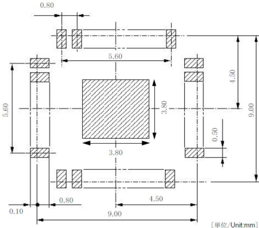
実装基板のフットパターンの設計の際には、実装の容易さ、接続の信頼性、配線の引き回し、半田ブリッジ発生のないことなどを十分考慮してください。
